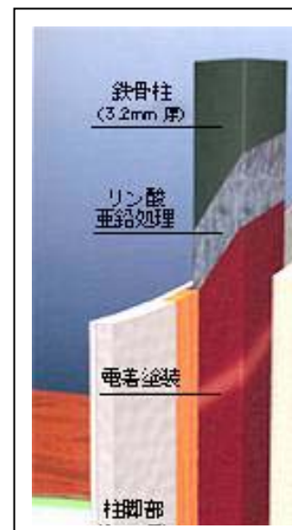
万全の防錆処理を施した鉄骨柱（1階部分）
