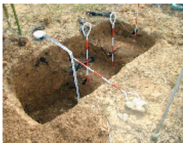
センサーの埋設
